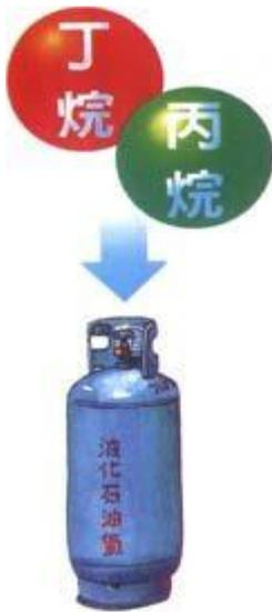
液化石油氣係由原油煉製或天然氣處理過程中所析出的丙烷與丁烷混合而成，在常溫常壓下為氣體，經加壓或冷卻即可液化，通常是加壓裝入鋼瓶中供用戶使用，故又稱之為液化瓦斯或桶裝瓦斯。
